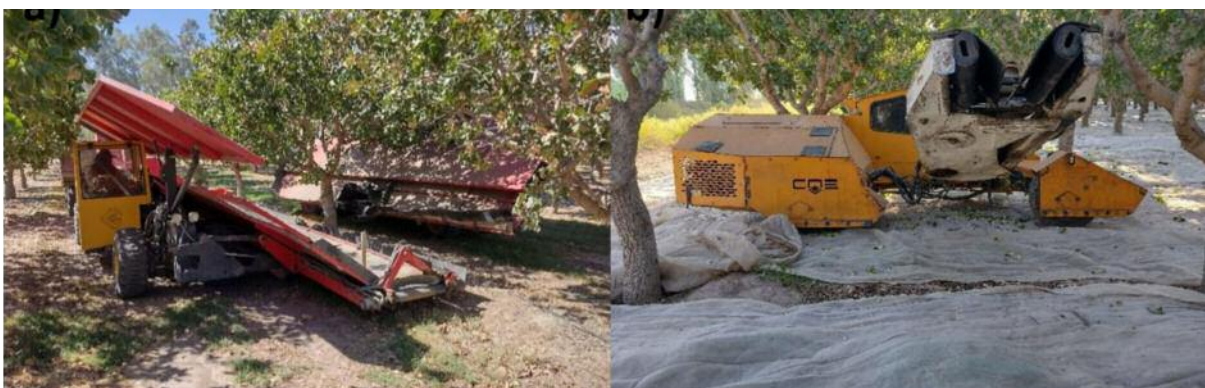
Figura 3. Cosechadoras autopropulsadas durante la recolección de pistachos. A) Cosechadora tipo Side By Side. B) Cosechadora tipo vibrador de tronco
