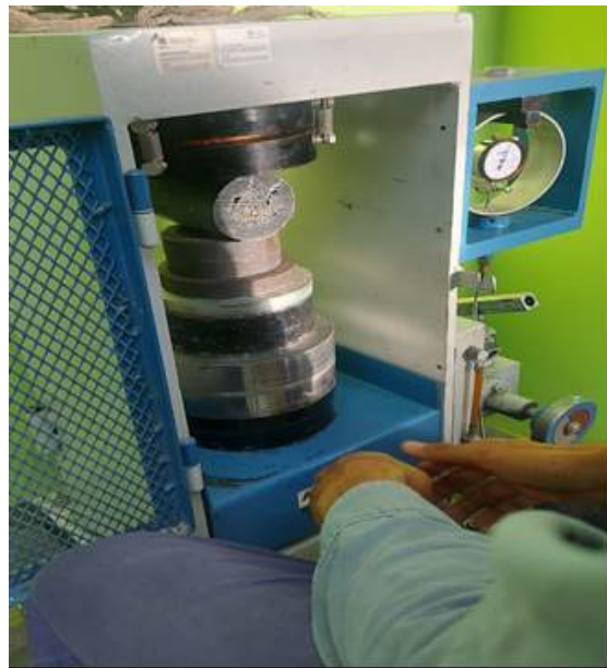
Figura 5: Ensayo de compresión diametral
