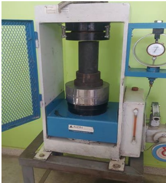
Figura 4: Ensayo de compresión uniaxial
