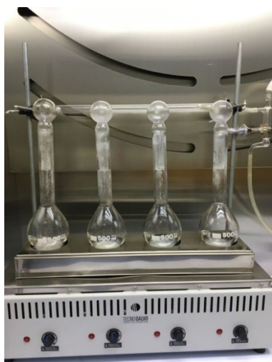
Fig. 1. Digestión de muestra de compost en H 2 SO 4 y ácido salicílico Kjeldahl.
