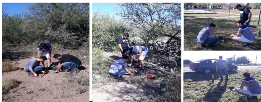
Figura N° 3: Proceso de medición de resistividad de los suelos de la zona este. Ciudad de La Rioja – Argentina
